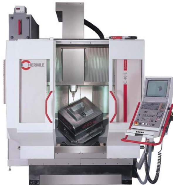
Diese Werkzeugmaschine ist mit einem Abscheider für Ölnebel aus Kühlschmierstoffen ausgestattet (oben links).
