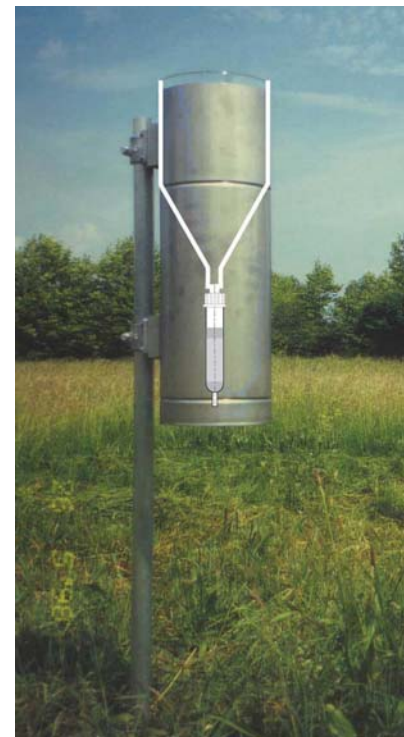
Die „Trichter-Adsorberkartusche“ im Einsatz: Mit ihrer Hilfe wird der Eintrag aus der Atmosphäre gemessen.
