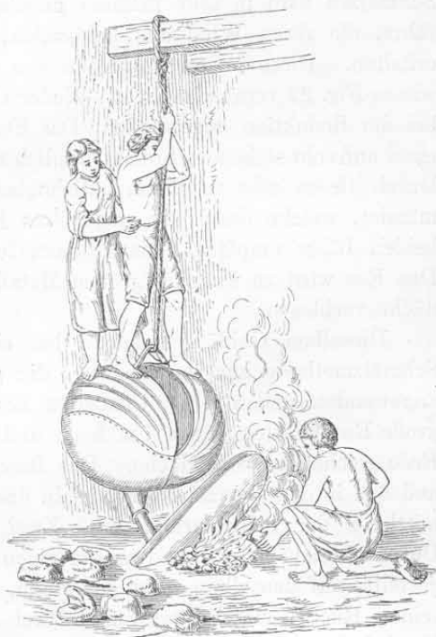
Fig. 22. Eisengewinnung in den Khasiabergen. Nach HOOKER.
