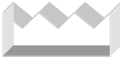
Abbildung 21: Glasrack zur Anfertigung von Detektionsfenster in Kapillaren
