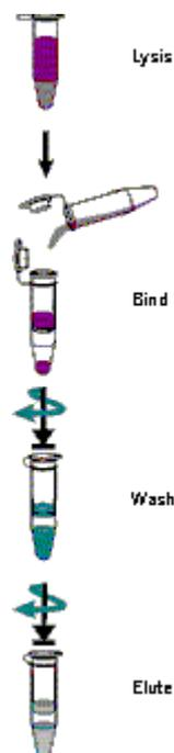
Abbildung 39: Schema Isolierung DNA mit Invisorb®Spin Cell Mini Kit
