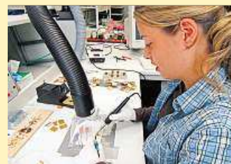
Physik-Studentin Alexandra Argyrakis verlötet Kleinteile für die Detektorplatten.
