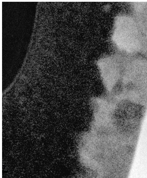
Abbildung 42: Elementverteilungskarte des Sauerstoffs in 200 nm Nb auf SiO 2 nach Reaktion in NH 3 bei 900°C. Vergrößerung: 350 000fach
