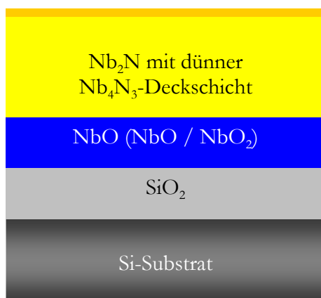
Abbildung 48: Aufbau des Films nach der Nitridierung in Stickstoff
