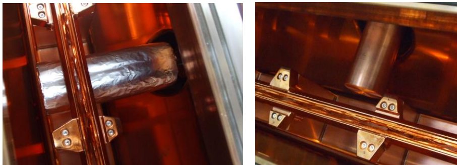
Abb. 6.36: Modell eines Tauchkolbenzylinders mit maximaler Störung und der daraus resultierende Kupferzylinder.
