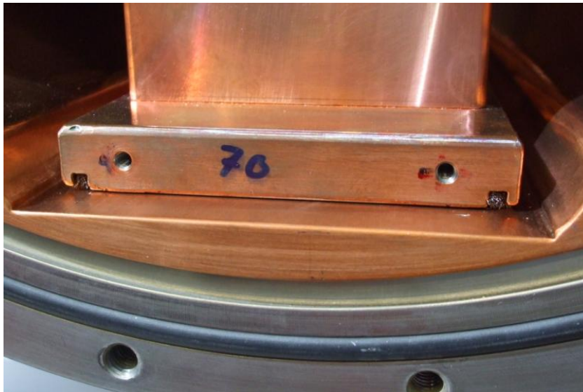
Abb. 6.21: Ansicht der Bodenplatte mit dem versilberten Drahtgeflecht als HF-Dichtung.
