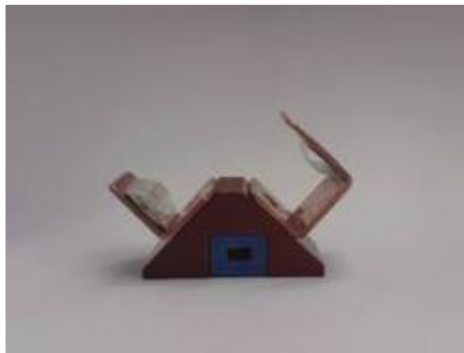
Abb. 5.5: Störkondensator mit Schalter. Dieser wird auf zwei entgegen gesetzte gepolte Elektroden gesetzt um damit die dadurch entstehende Frequenzverschiebung zu messen.
