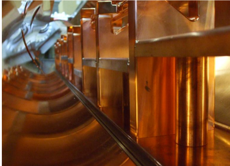
Abb. 6.28: Eingebaute Tuningplatten mit untergesetzten Kupferzylindern, mit denen die Platten fixiert werden.
