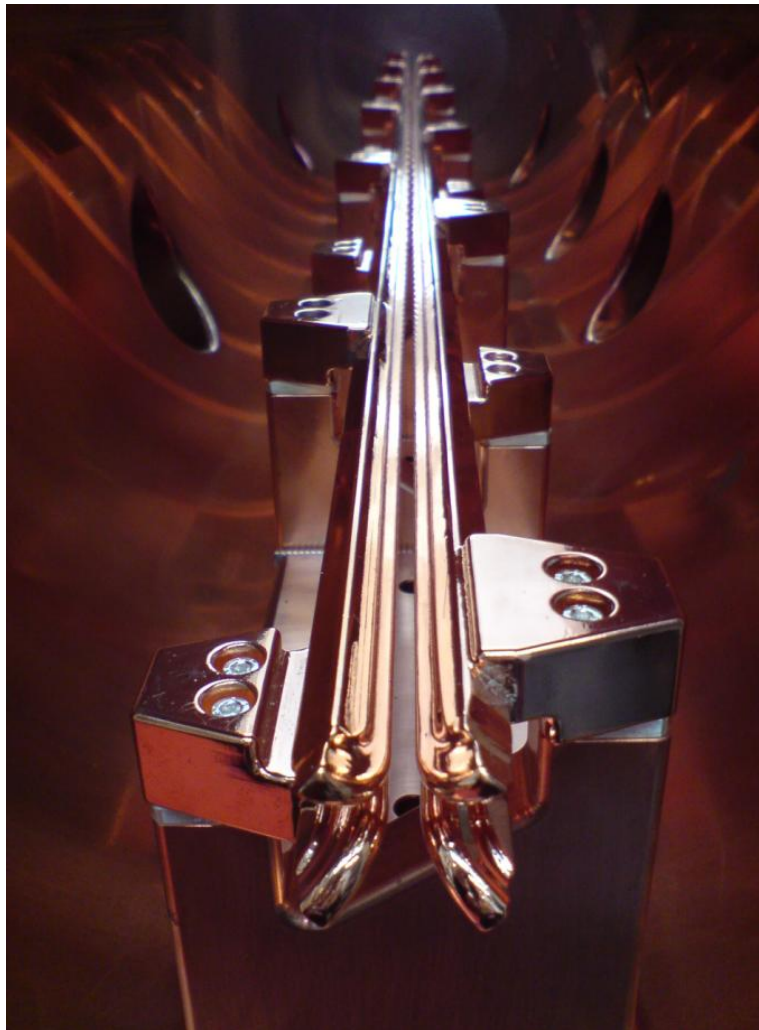
Abb. 6.22: Elektroden im Eingangsbereich mit untergelegten Distanzplättchen für die vertikale Justierung.
