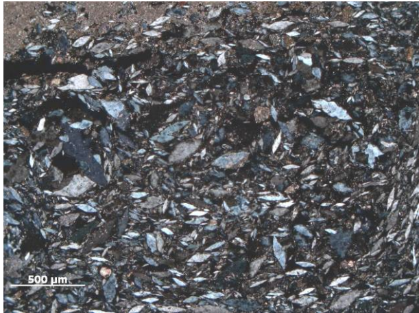
Abb. 4.7: Gipsestrich mit linsenförmigen Gipskristallen (XPL).
