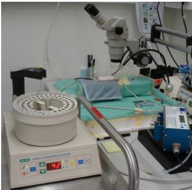
Abbildung 21. Aufbau der Mikrodialyseversuche während der Schlaganfalloperation. Die Maus liegt narkotisiert in dorsaler Position auf dem Heizpad (Mitte). Die Pumpe ist rechts hinten im Bild und der Fraktionssammler, auf einen Transportwagen gestellt, links vorne angeordnet.
