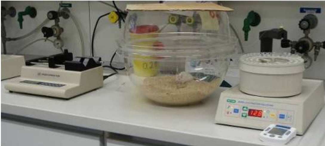
Abbildung 20: Aufbau der Mikrodialyseversuche. Dargestellt ist die Probengewinnung im wachen Zustand der Maus (Mitte). Auf der linken Seite befindet sich die Pumpe mit der Spritze und rechts der Fraktionssammler.
