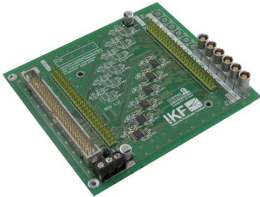
Abb. 14: Alice TPC GGP-Ctr. LVDS/PIO-Adapter & Fanout Die Alice TPC Gating-Grid-Control-LVDS/PIO-Adapter & Fanout-Karte wurde für Test- und Simulationszwecke der Alice TPC GGP Überwachungs-Baugruppen entwickelt. Das Bord enthält 12 frei konfigurierbare LVDS/(LV)TTL Driver/Receiver-Bausteine, sowie eine pin-kompatible Schnittstelle für die National Instruments PIO96 Karte.
