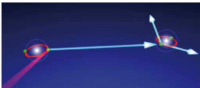
Abb.1 Schematische Skizze des interatomaren Two-Step-Prozesses. Das Photoelektron streut am zweiten Atom und ionisiert dieses. Im Endzustand können dadurch zwei Helium-Ionen und zwei Elektronen detektiert werden.
