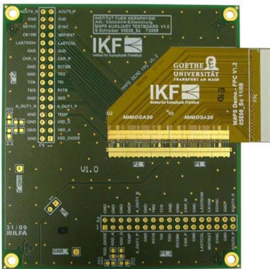
Abb. 23: MAPS Auxiliary Testboard Das Testboard das aus einer Hauptkarte und einer MAPS-FPC-Tochterkarte besteht, ist wie alle benutzten MIMOSA20 Chips via Bonding-Technologie verbunden.
