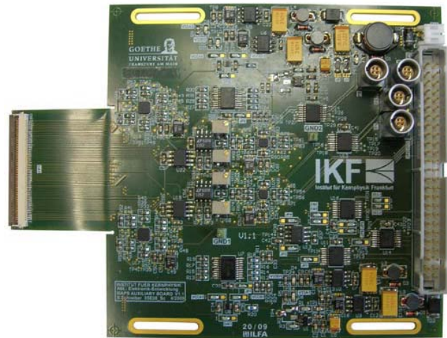
Abb. 20: MAPS Demo.- Aux Board Die Kombination eines starren und eines flexiblen Leiterplattenbereiches ermöglicht eine gute mechanische Flexibilität beim Einbau in die Strahlapparatur.
