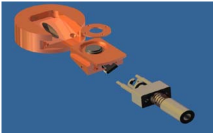
Abb.1: Transfersystem bestehend aus 3 Teilen. Basis, Schublade mit Probe und Tool, um Schublade auf Basis im Vakuum festzuschrauben.
