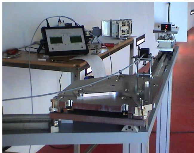
Abbildung 2: Laser-Justierbank zur Einrichtung der Spiegel in den 75^\circ - Zylinderdeflektoren (CSD). Im Vordergrund ist eine der 3-Punkt-Halteplatten zu sehen, wie sie in der vier FLSR Sektorkammern eingebaut und mittels Laser ausgerichtet werden. Das CSD Element (im Hintergrund auf dem Tisch) ist mit einem Dreifuß und einem Justierspiegel versehen und wird auf der Laserbank eingerichtet. Es wird dann lediglich auf die, justierten 3-Punkt-Halteplatten im Ring aufgesetzt und fixiert.
