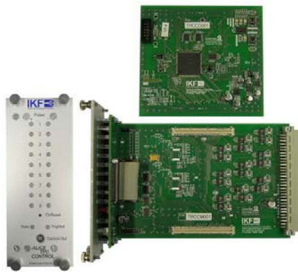
Abb. 9: Alice TPC Überwachungs-Baugruppe
