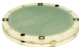
Abbildung 3.17: Darstellung der Wedge & Strip Anode, wie sie in diesem Experiment verwendet wurde.
