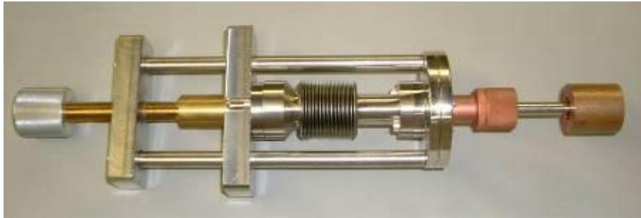
Abb. 8.12: Manuell verstellbarer Tauchkolben des Debunchers
