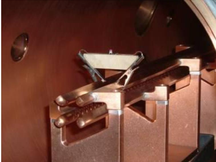
Abb. 8.7: Abbildung des Störkondensators auf der ersten RFQ-Zelle
