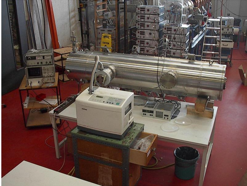
Abb. 8.15 : Abschließender Lecktest des HITRAP RFQ-Abbremsbeschleunigers mit montiertem Debunchertank
