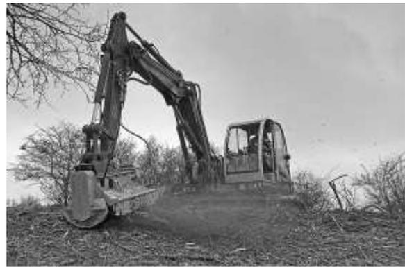
**Abb. 8:** Mit der am Bagger montierten Stubbenfräse werden die Stubben bodengleich abgefräst. (Foto: Frank GRAWE).
