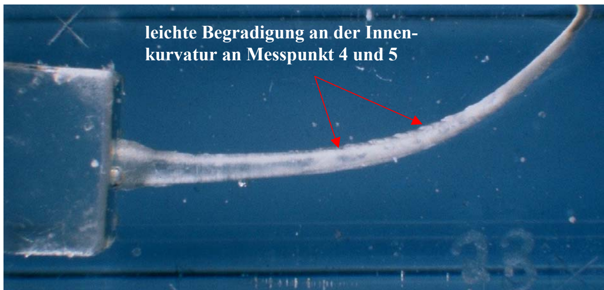
Abb.36 : Wurzelkanalmodell 23 nach Aufbereitung mit Prototyp b (VDW)
