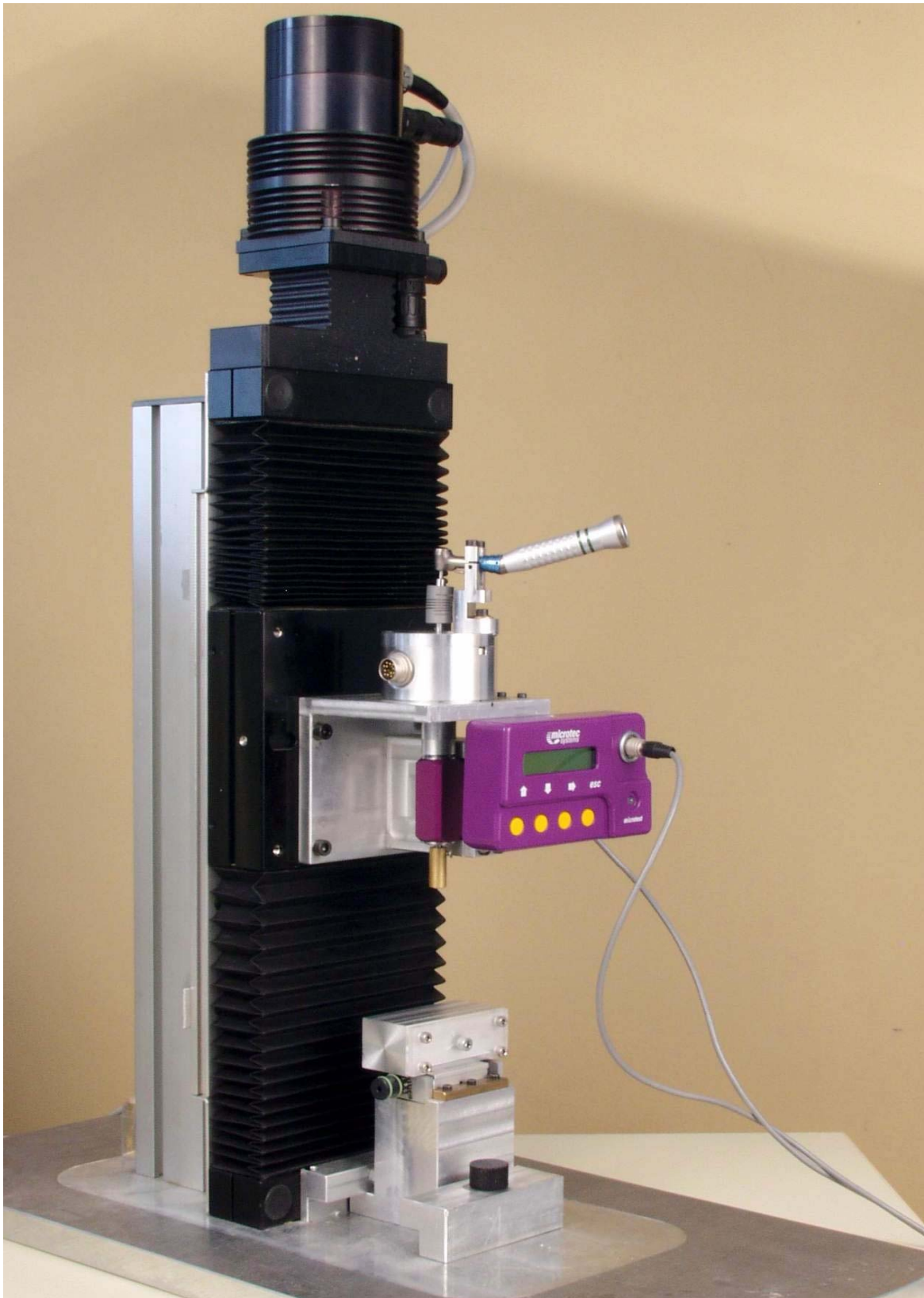
Abb.11 : Versuchsanlage der Firma Phytron (Gröbenzell, Deutschland) zur Prüfung der Eigenschaften der beiden TCM Endo-Motoren
