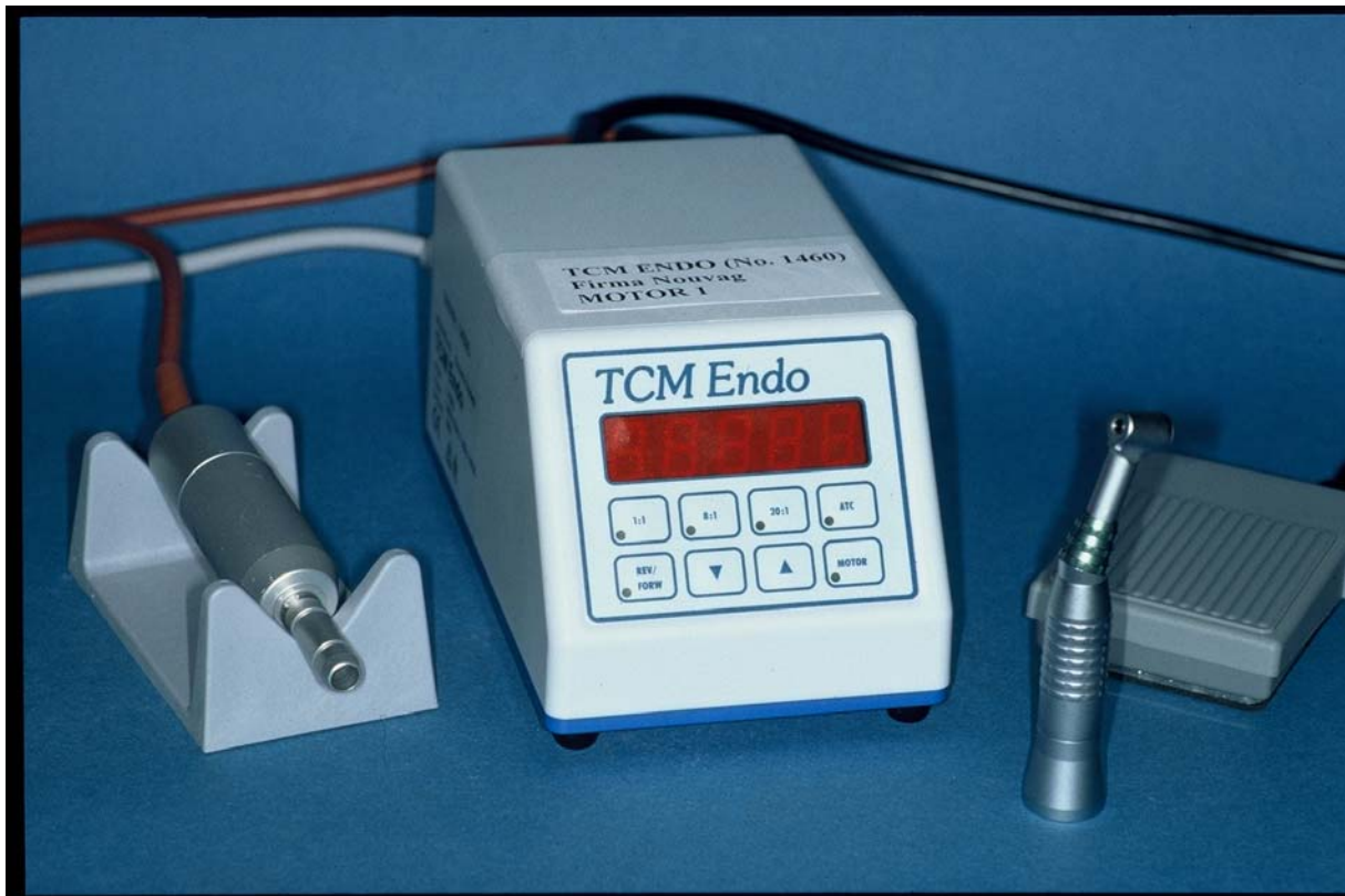
Abb.10 : TCM Endo-Micromotor mit Fußpedal, Winkelstück (8:1-Übersetzung) und Maschinensteuergerät (hier 1C)
