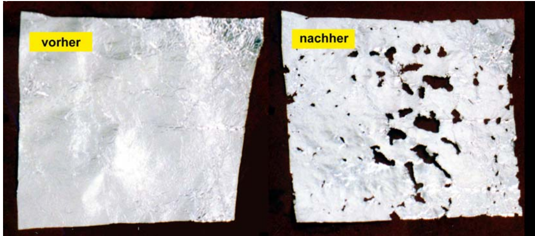
Abbildung 30: Aluminiumfolie nach einer Minute Behandlung im Ultraschallbad.
