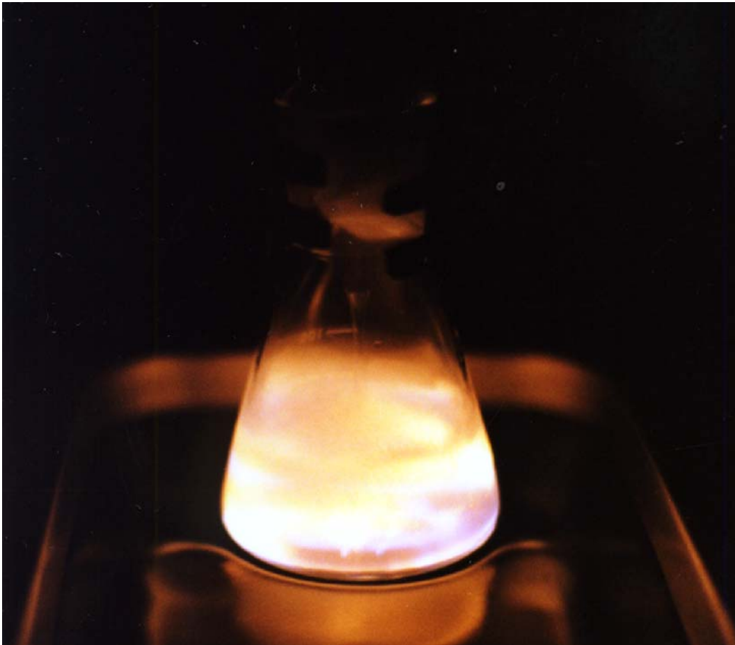
Abbildung 36: Sonolumineszenz von konzentrierter Natronlauge im Argonstrom
