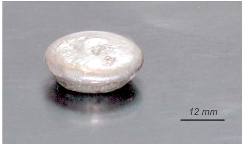
Abbildung 56: Mit AST-Technik hergestellter Silberregulus
