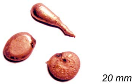
Abbildung 57: Mit AST-Technik hergestellte Kupferreguli
