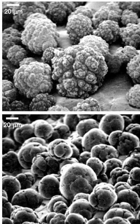
Abbildung 18: Nickeloberfläche vor (oberes Bild) und nach (unteres Bild) Einwirkung von Ultraschall [100].
