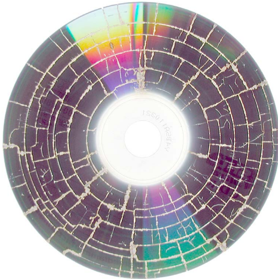
Abbildung 41: CD-ROM nach Bestrahlung im Mikrowellenofen
