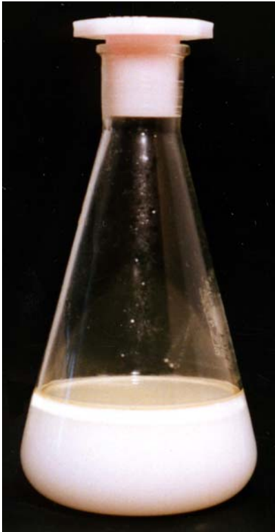
Abbildung 31: Ergebnis der Öl/Wasser-Emulgation nach sechs Monaten Standzeit nach Beschallung
