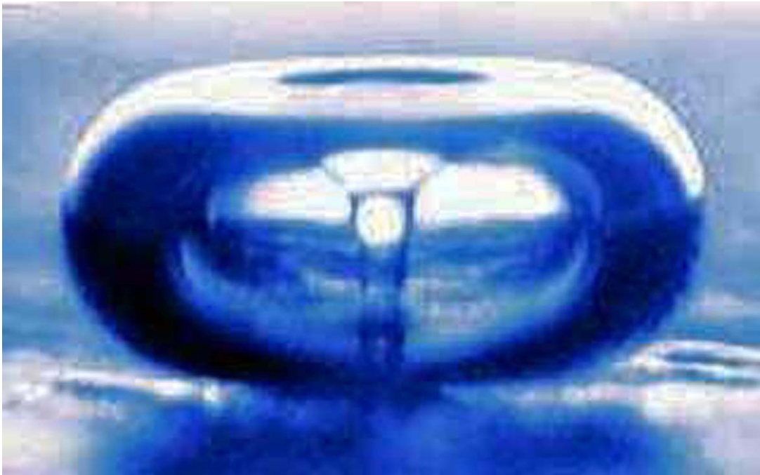
Abbildung 7: Hochgeschwindigkeits-Blitzlicht-Mikroaufnahme der Implosion einer Kavitationsblase an einer Phasengrenzfläche [34].
