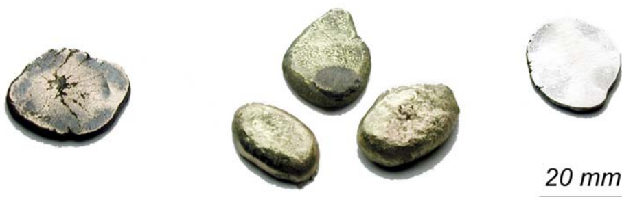
Abbildung 59: Mit AST-Technik hergestellte Messinge: Rotmessing (Links), Gelbmessing (Mitte) und Weißmessing (Rechts)
