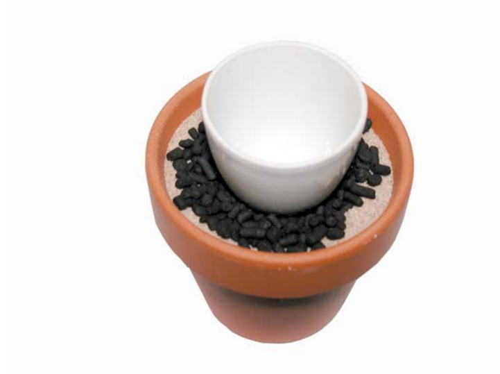
Abbildung 44: AST-Element mit Sandschüttung und gekörnter Aktivkohle als Suszeptor
