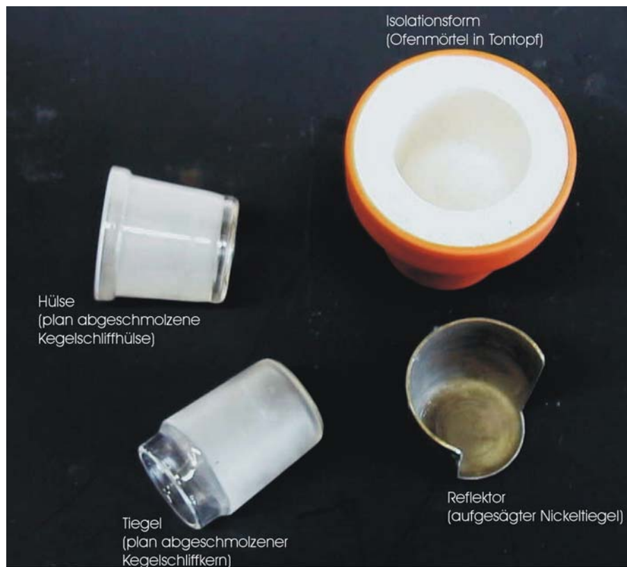
Abbildung 49: Bauteile für das GST-Element aus Quarzglas gefertigt
