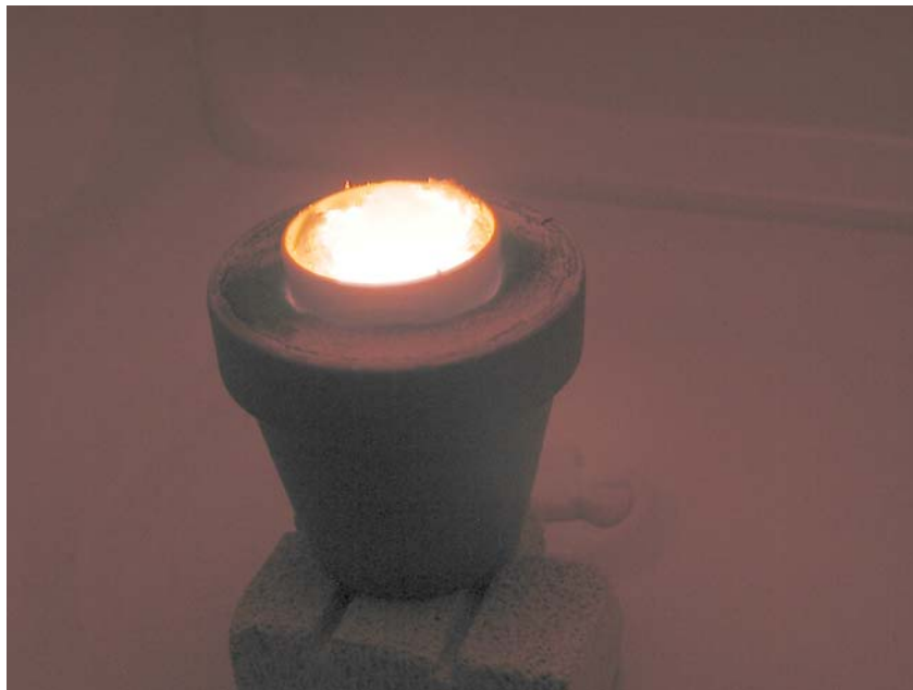
Abbildung 54: Glasschmelze während der Bestrahlung im AST-Element im Mikrowellenofen
