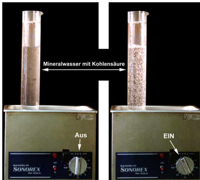
Abbildung 33: Entgasung von Mineralwasser in einem Glaszylinder im USB
