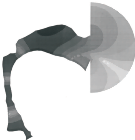
Bild 5.2: Mittels Finite-Elemente berechnete Schallintensität bei 5,3 kHz während der Artikulation des Lautes [a]. Jede Graustufe entspricht einem Intensitätsbereich von 6 dB; dunklere Bereiche weisen eine höhere Intensität auf. Dargestellt ist ein Querschnitt des Rachens ( Pharynx ), links unten, und der Mundhöhle ( Cavum oris ), darüber mittig, an die sich rechts ein halbkreisscheibenförmig dargestellter halbkugelförmiger Abschnitt zur Erfassung der Lippen-Schallabstrahlung anschließt.
