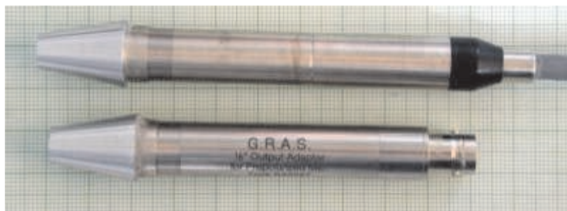
Bild 10.1: Schallwandler: oben Mikrofon mit angeschraubten Vorverstärker, unten Signalgeber. Beiden sind Konen aufgesetzt, um eine schalldichte Schalleinleitung in den Nasaltrakt zu gewährleisten.
