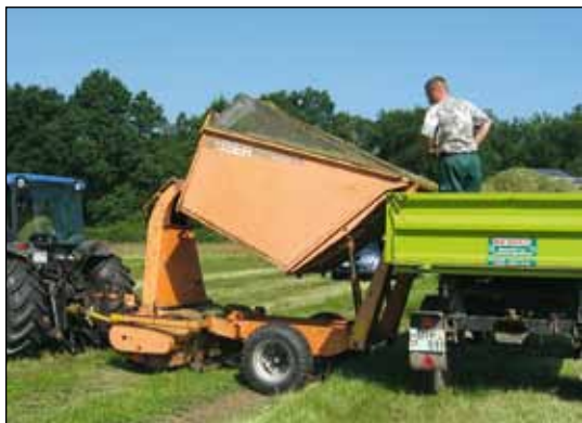
Abb. 3: Übertragung des Mahdgutes vom Mähcontainer auf den Anhänger zum Transport zu den Renaturierungsflächen. Foto: G. Warthemann.
