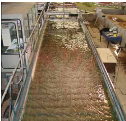
Abb. 6a: Laborrinne im Theodor-Rehbock-Wasserbaulaboratorium. Foto: S. Schneider.
