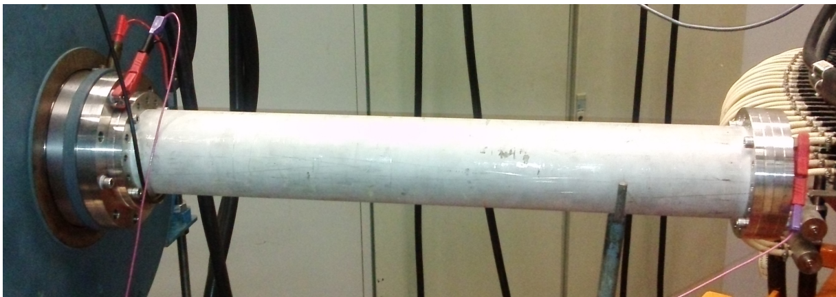
Abbildung 3.12: Teilweise aufgebauter Filterkanal in Tassenkonfiguration
