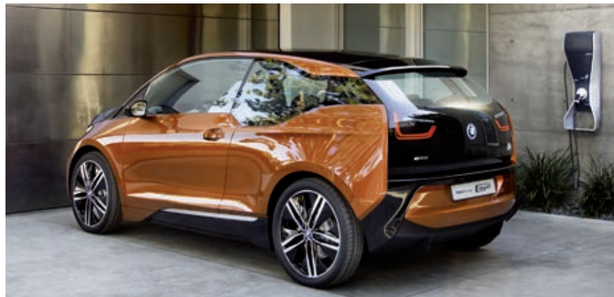
BMW präsentierte auf der IAA einen um Batterie und Elektromotor herum völlig neu konstruierten Wagen in Leichtbauweise aus Carbonfasern, den BMW i3 .
