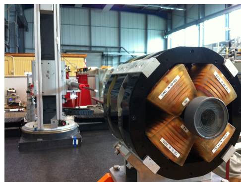
Abbildung 3.1: Links : Aufgebautes Triplet (UFFFRANZ02) am Messstand. Dahinter steht der Messturm mit Sondenstab und Hall-Sondenkopf auf dem Granitblock. Rechts im Bild sind die Strom- und Wasseranschlüsse erkennbar. Rechts : Nahaufnahme eines Quadrupoltripletts mit Messaufbau im Hintergrund.
