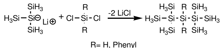
Schema 17: Wurtz-artige Kupplung mit Halogensilanen.
