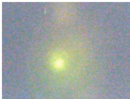
**Abb. 7.4:** *Heliumionenstrahl auf den Leuchtschirm fokussiert bei einem Solenoid-Magnetfeld von 0,37T*
