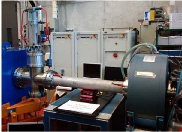
Abbildung 5: Links: Eingebauter und angeschlossener Filterkanal mit zugehörigem Solenoid Rechts: Messung und Filterung eines Wasserstoffionenstrahls mittels Filterkanal.
