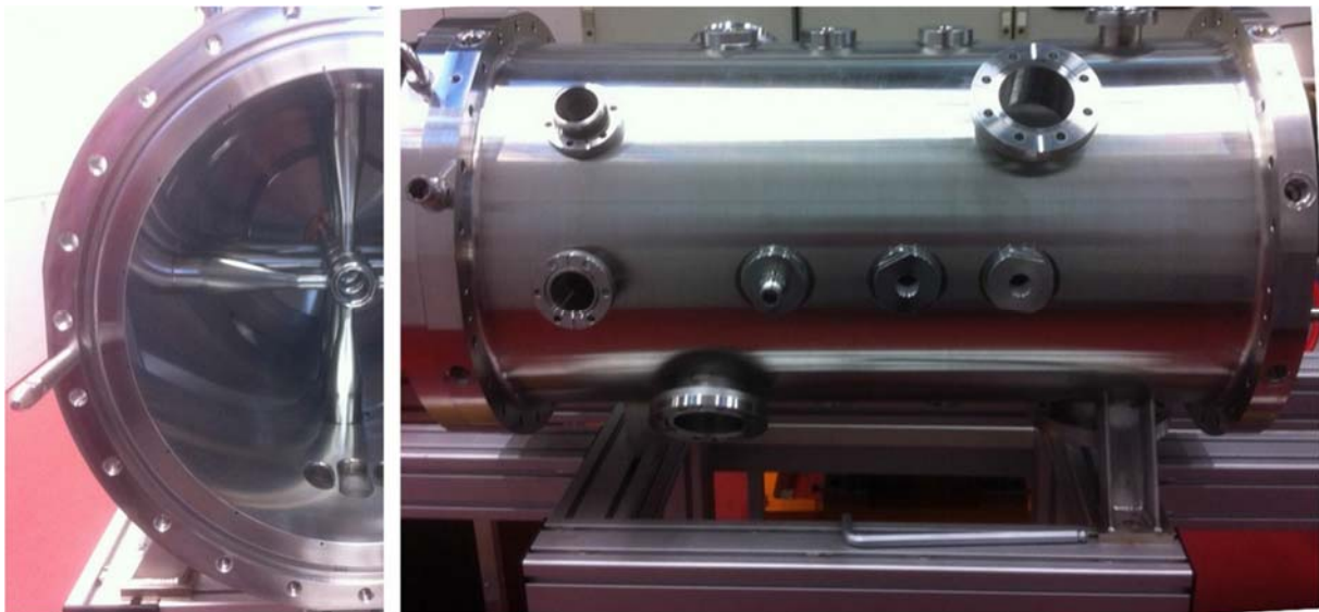
Abbildung 3: 325 MHz Hochfeldkavität vor dem Verkupfern.
