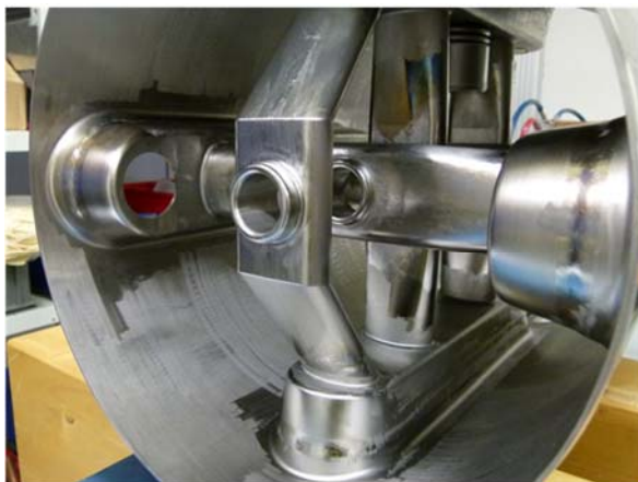
Abbildung 1: Foto der 325 MHz CH-Kavität (links) und verschiedenen Kaltmessungen zur Bestimmung des Gradienten (rechts).
