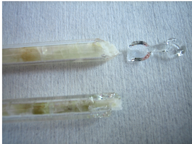
Abbildung 4.11: Zwei geborstene Borosilicatröhrchen. Das obere mit 1,5 mm, das untere mit 1 mm Wandstärke.
