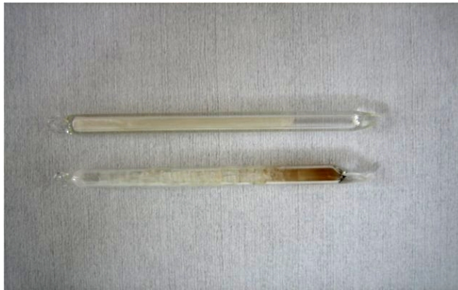
Abbildung 4.10: Fluoranthen vor und nach dem Zonenschmelzen. Die untere, bearbeitete Probe weist neben der Aufkonzentration der Fremdstoffe am unteren Ende einen Freiraum oben in Richtung des Häkchens auf.
