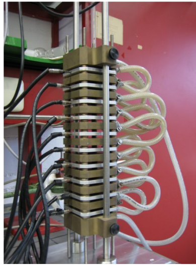
Abbildung 4.3: Übersicht über den Heiz-,Kühlteil der Zonenschmelze. Rechts sichtbar sind die Schlauchverbindungen der Kühlkörper (Messingteile).
