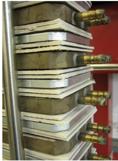
Abbildung 4.5: Nahaufnahme der Isolationsplatten aus isoplan ® 1000. Die Schlauchverbindungen der Kühlelemente sind hier entfernt.
