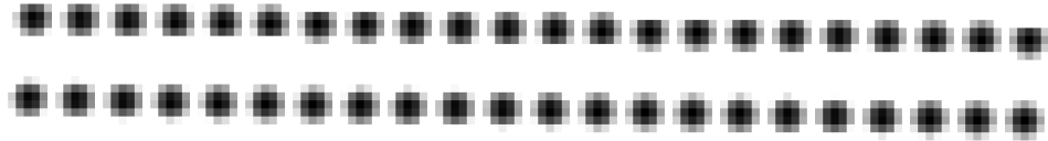
Abbildung 7.6: Vergrößerte Darstellung bewegter Punkte: originale Methode mit sichtbaren Artefakten (oben) und Rendering mit prozeduralen Shader (unten)
