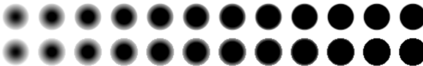
Abbildung 7.7: Vergrößerte gleichgroße Punkte mit unterschiedlicher Härte (aufsteigend nach rechts): mit Antialiasing-Filter (oben) und ohne (unten)
