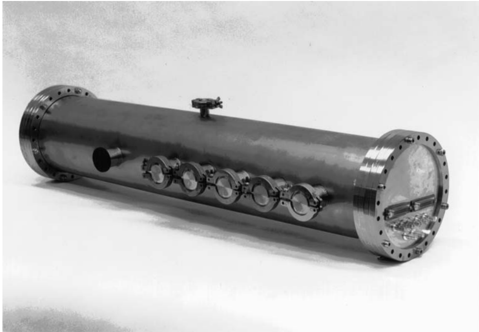
Abbildung 4.3 Der TPC-Aufbau wird in einem Edelstahlrohr eingebaut. Durch Evakuieren und anschließendes Befüllen mit Zählgas kann schnell eine gute Gasqualität erreicht werden. Die \beta -Quelle und der Proportionalzähler werden in zwei gegenüberliegenden KF40 Flanschen eingebaut. Die Elektronikkarte mit 16 ladungsempfindlichen Vorverstärkern wird außen an den Durchführungen des CF200 Flansches angebracht [31].
