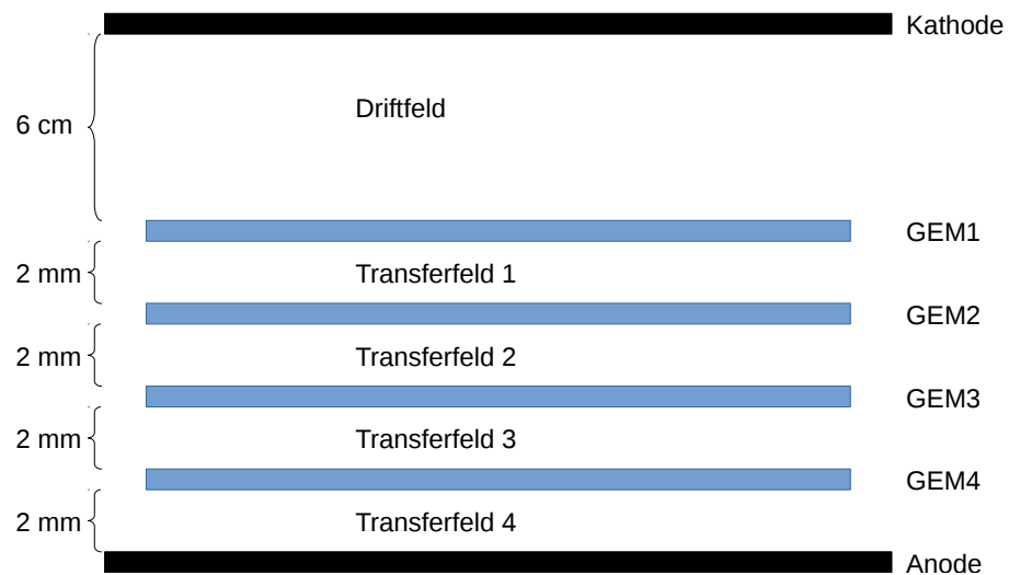
Abbildung 8: Schema des GEM-Teststandes.
