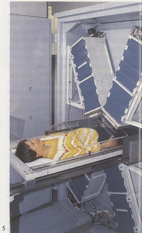
Abbildung 5 zeigt einen Ganzkörperzähler zur Messung radioaktiver Stoffe im Menschen unabhängig von der Verteilung im Körper. Das Gerät wurde vom Institut für Biophysik der Universität mit Förderung der Deutschen Forschungsgemeinschaft entwickelt. Die äußere Strahlenabschirmung ist geöffnet, um die Anordnung der vier Detektoren zu zeigen.
