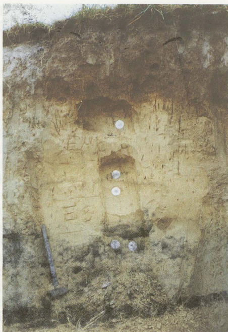
Abb. 6 und 7: Schema (nach Semmel) und Foto des Lößprofils in Wiesbaden-Gräselberg. Stechzylinder sind in unterschiedlicher Tiefe zur Probenentnahme eingesetzt und im Schema durch die Tiefe gekennzeichnet.
