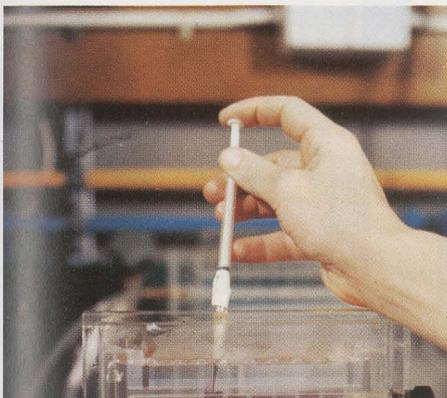
Proben von DNA werden in einem elektrischen Feld aufgetrennt. Die Kammer enthält ein Gel von der Konsistenz einer Sülze. Das Foto zeigt, wie DNA-Proben in kleine Schächte gespritzt werden, bevor das elektrische Feld angelegt wird.
