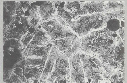
Die hundertfache Vergrößerung des Luppeneisens zeigt dem Fachmann eine wohlbekannt Struktur („Widmannstätten-Struktur“), die auf einen hoch inkohlten Stahl hindeutet. Es handelt sich dabei um ein Gitterwerk aus Perlit, hier hellgrau, mit vier- bis sechseckigen Flächen aus Magnetit.
