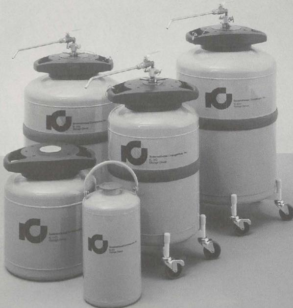
Lager- und Transportbehälter aus Aluminium oder Edelstahl für verflüssigte, tiefkalte, atmosphärische Gase -Stickstoff, Sauerstoff, Argon, Helium - In horizontaler und vertikaler Bauweise mit Volumen von 4 - 5000 Litern gemäß TÜV, GGVS, ADR, Bauartzulassung und allen ausländischen Abnahmen.
