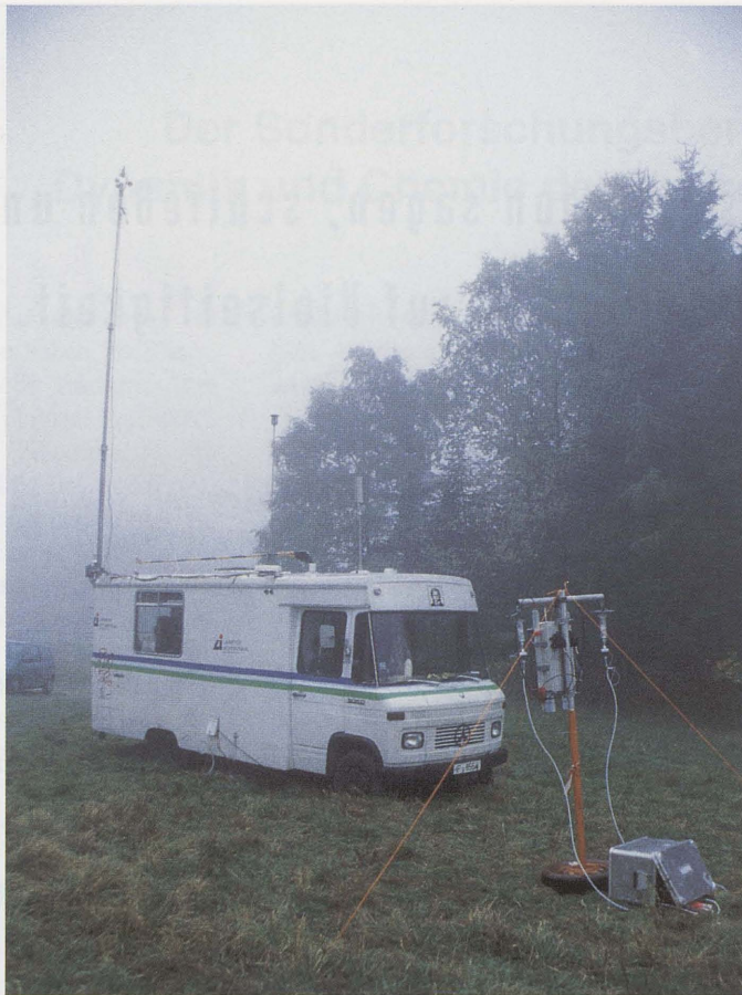
Abb. 6: Ein Meßwagen des Zentrums für Umweltforschung als mobile Meßstation unterhalb der Wolkenbasis bei Oberreifenberg.
