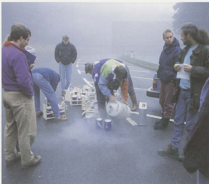
Abb. 4: Argonausgabe am Treffpunkt auf dem Kleinen Feldberg. Anschließend mußten die hier versammelten Studenten die Probenahmeausrüstung, bestehend aus einem Meßkoffer mit Luftpumpe sowie mehreren Thermogefäßen mit flüssigem Argon, an dem für sie bestimmten Meßort in Stellung bringen und insgesamt fünf Proben ziehen. Nach Beendigung der Probenahme wurden die ausgefrorenen Luftproben im Argonbad in das Labor des Zentrums für Umweltforschung gebracht und dort mit Gaschromatographie und flammenphotometrischem Detektor auf ihren Gehalt an SF 6 hin untersucht.
