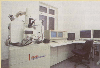
Die am Institut für Mineralogie installierte Elektronenstrahlmikrosonde Jeol Superprobe JXA 8900 RL.
