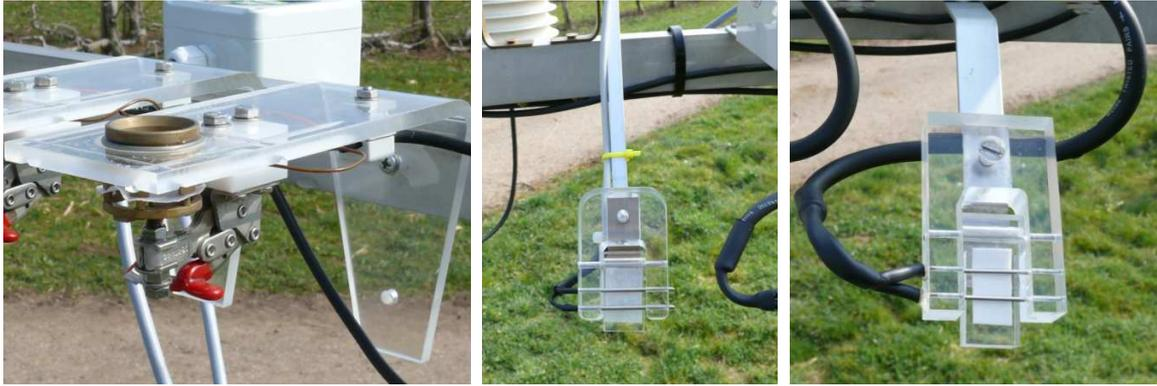
Abb. 7: Die auf dem Prinzip von Leitfähigkeit basierenden (vliesbasierten) Blattnässesensoren der Firmen LUFFT, PESSL und TOSS (von links nach rechts).
