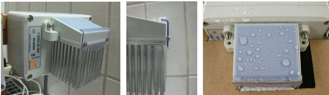
Abb. 36: Prototyp 6 mit Ablaufschild (links und Mitte) und mit Kragen.
