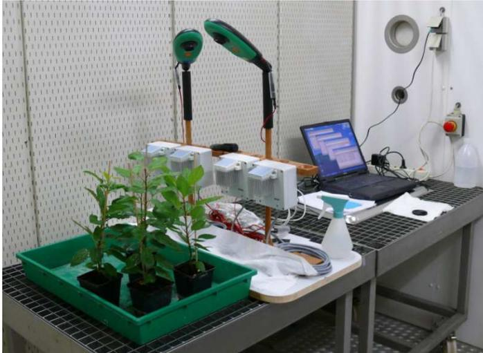
Abb. 11: Versuchsaufbau zur Validierung der neu entwickelten Blattnässesensor-Prototypen 5-7 in der Klimakammer.
