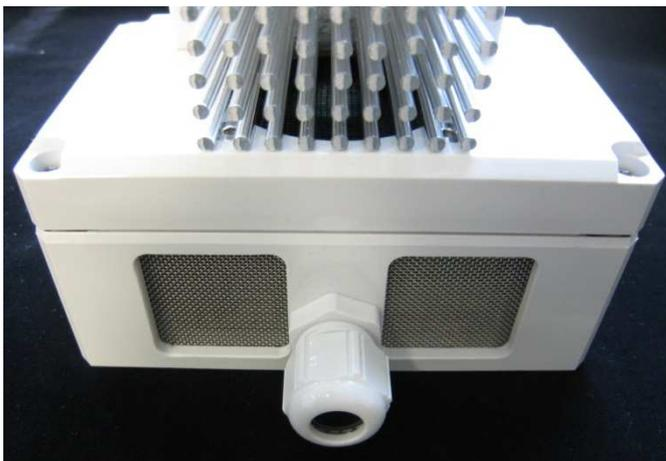
Abb. 10: Ventilationsöffnung des Sensor-Prototyps 7 unten am Gehäuse und hinter dem Kühlkörper.
