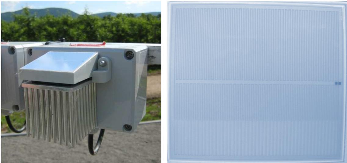
Abb. 9: Der marktreife Prototyp 7 und die eingesetzte glaskeramische Oberfläche mit leiterbahnfreier Zone am unteren Rand.
