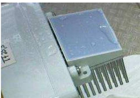
Abb. 35: Bildung großer Wassertropfen auf der Sensoroberfläche bei Prototyp 5 nach Benetzung
