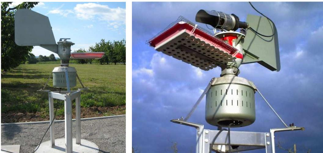
Abb. 12: Sporenfalle im Versuchsfeld mit vorgelagertem Blattdepot und aufgesetzter Lichtquelle (rechts).
