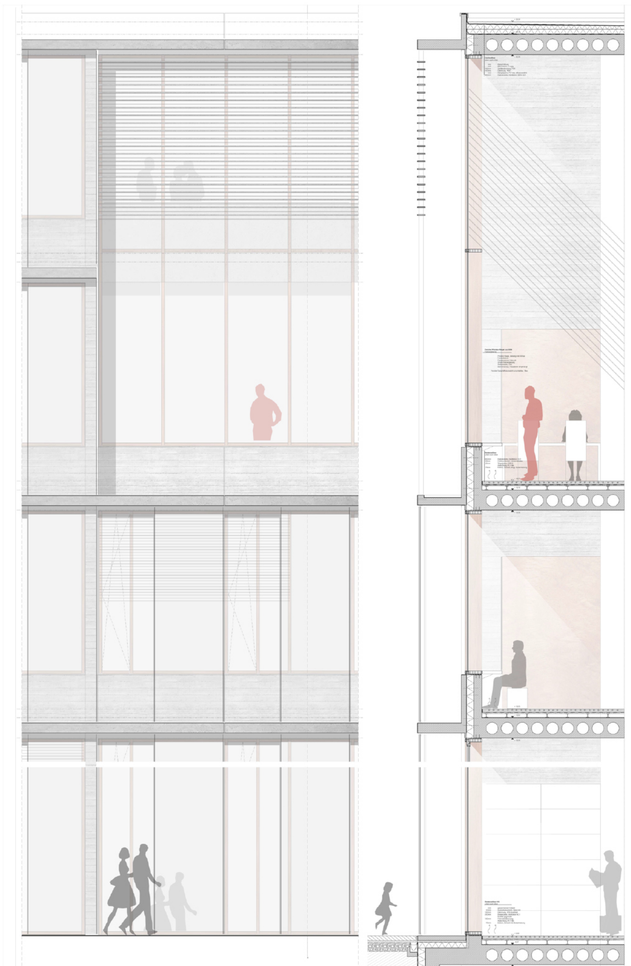
Teilschnitt und Schnitt durch die Fassade, Doppelfassade aus vorgehängten Fertigteilen und Stahlbetondecken mit hohen Verglasungen
