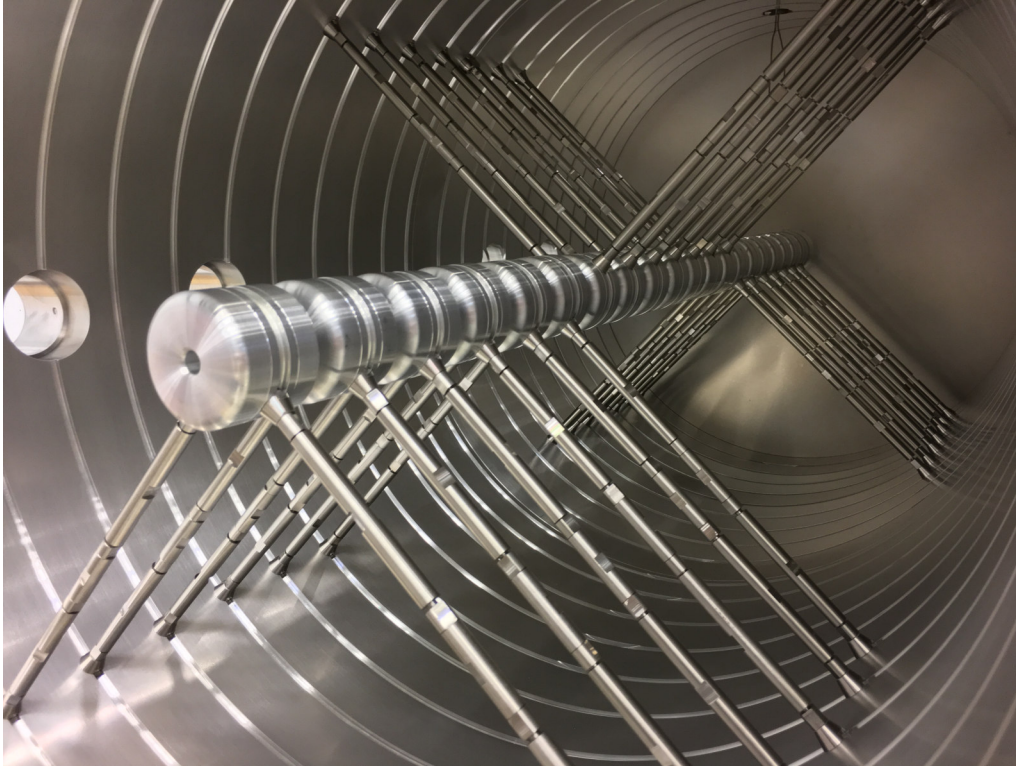
Abbildung 7.10: V-Stützen-Konfiguration 7+7+6 im erweiterten Modell mit 20 Driftröhren.
