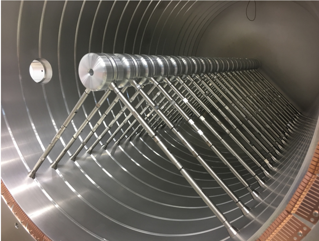
Abbildung 7.5: Originale V-Stützen-Konfiguration im erweiterten Modell mit 20 Driftröhren.
