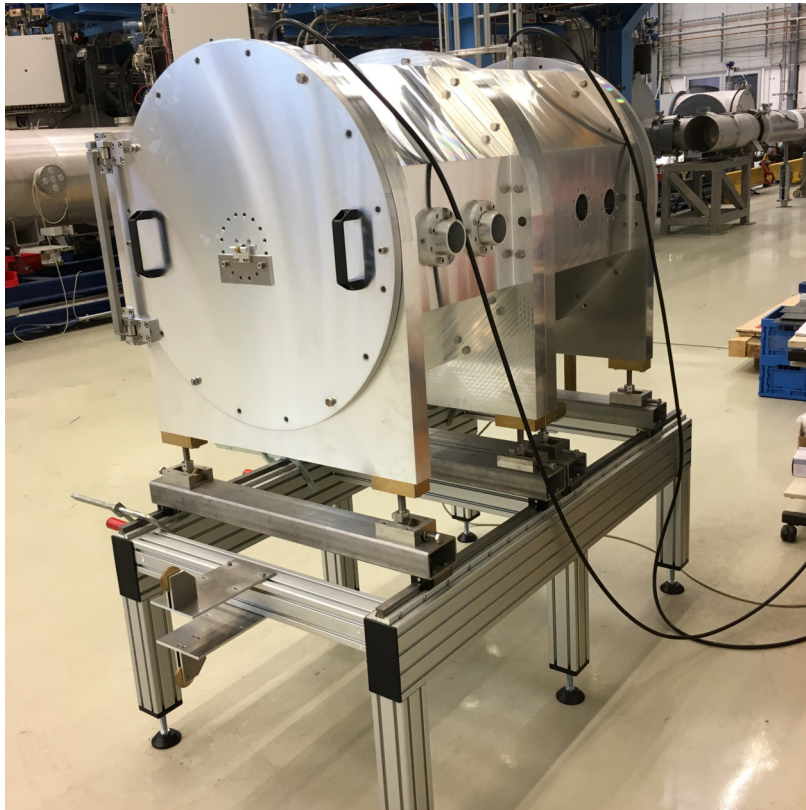
Abbildung 7.4: Zusammengesetztes Modell aus dem ursprünglichen Tank und einer Erweiterung mit insgesamt 20 Driftröhren.
