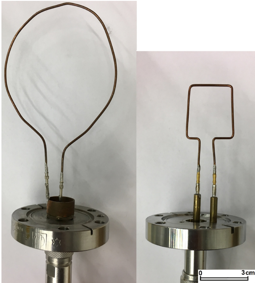
Abbildung 6.2: Ein- und Auskoppelschleife, um ein Signal in den Resonator zu senden und diesen in Schwingung zu versetzen.
