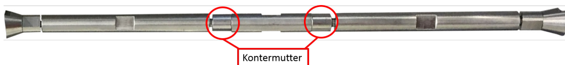
Abbildung 6.4: Stütze mit rechts-links-Gewinde zur Positionsveränderung der Driftröhren, Stabilität liefern jeweils zwei Kontermuttern.
