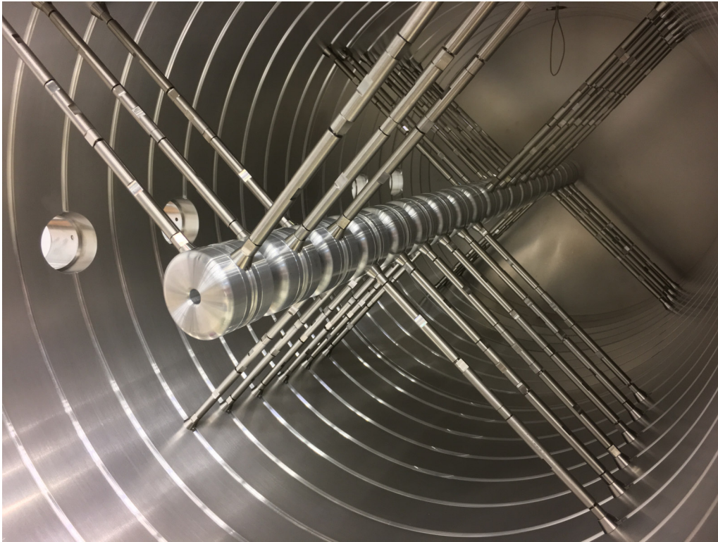
Abbildung 7.9: V-Stützen-Konfiguration 4+7+6+3 im erweiterten Modell mit 20 Driftröhren.
