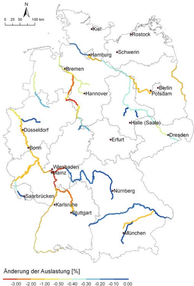
■ Abb. 24.1 Jahresmittelwerte der Auslastung thermischer Kraftwerke mit Durchlaufkühlung; Änderung 2055 gegenüber 2010 bei einer Lufttemperaturzunahme von 2°C. (Weisz et al. 2013)
