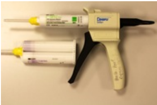
Abb. 8 - Replika Methode - zwei Kartuschen mit dünnfließendem Silikon
