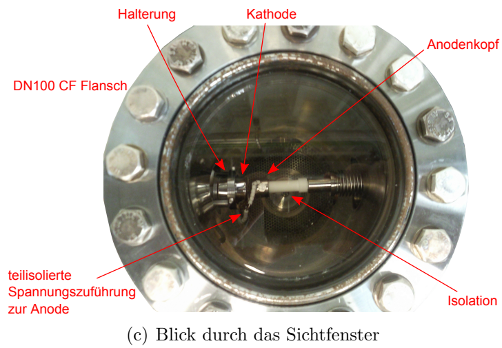
Abbildung 4.2.: Versuchsaufbau zur Untersuchung der Emissionseigenschaften der CNT-Kathode bei Raumtemperatur.
