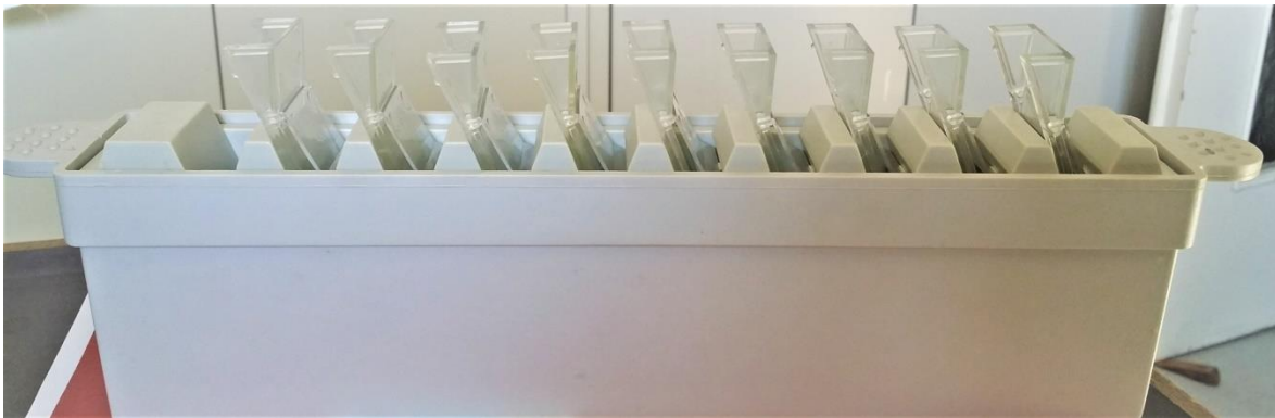
Abbildung 6.6 Halteapparat für Shandon Coverplates™ Alle Inkubations- und Spülschritte wurden hier durchgeführt (eigene Aufnahme)
