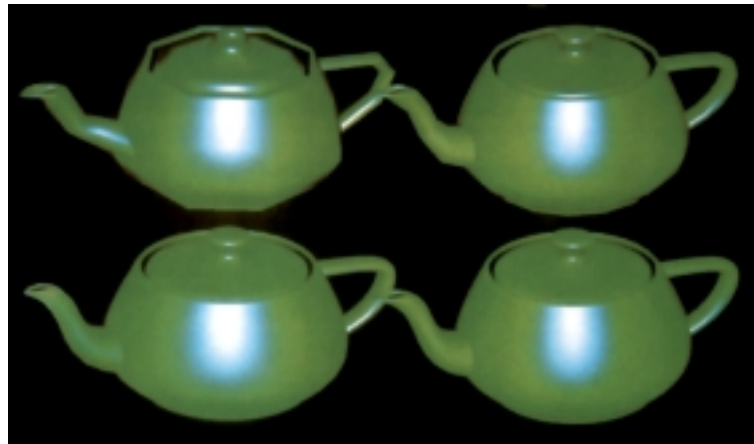
Abbildung 10: Bildgenerierung bei verschieden hoher uniformer Feinheit der Polygonmodelle [Watt00]
