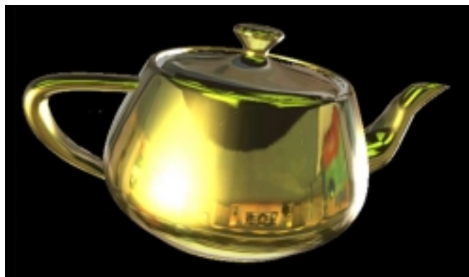
Abbildung 31: Schattierung auf der GeForce3-GPU mittels einer Variante des Cook-Torrance-Modells kombiniert mit Environment-Mapping [NVID02e].
