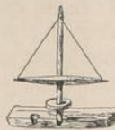
Fig. 307. Feuerzeug aus dem Westen des ostindischen Archipels. (Nach Pleyte.) Pumpenbohrer.
