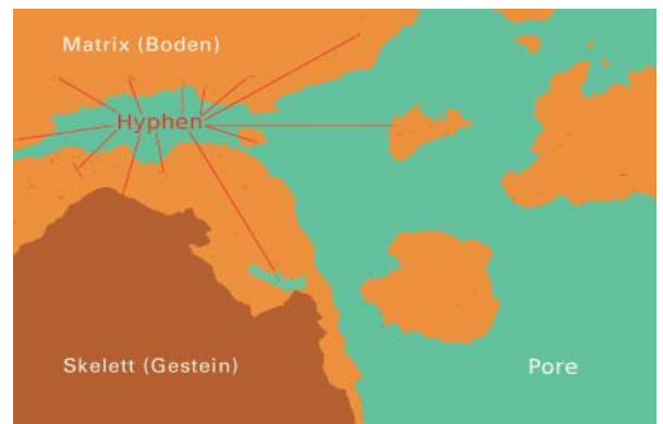
Digitalisierter Bildausschnitt eines Bodenanschliffs (Maßstab 1250:1). Mit einem geographischen Informationssystem (GIS) erfasster Blick auf 0,92 Quadratmillimeter untersuchte Fläche.
