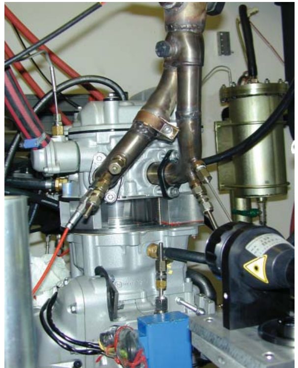
Der Versuchsmotor mit den Zugängen für die laseroptischen Messverfahren. Diese ermöglichen eine zweidimensionale Strömungsanalyse.
