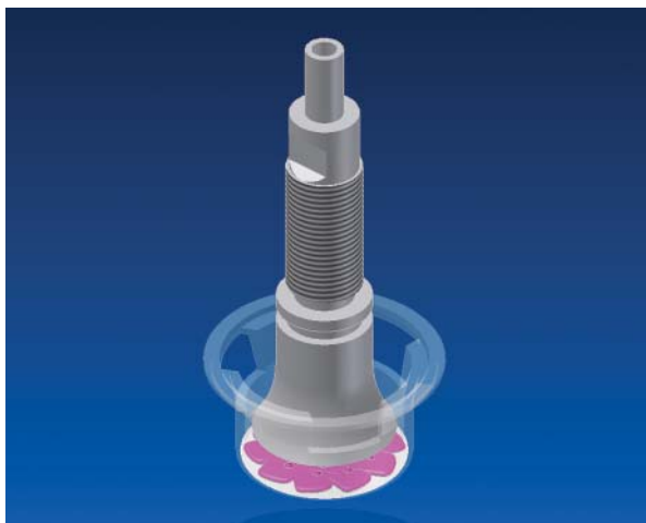
Einleitung eines Aerosols über einer Kulturschale für Zellkulturen
