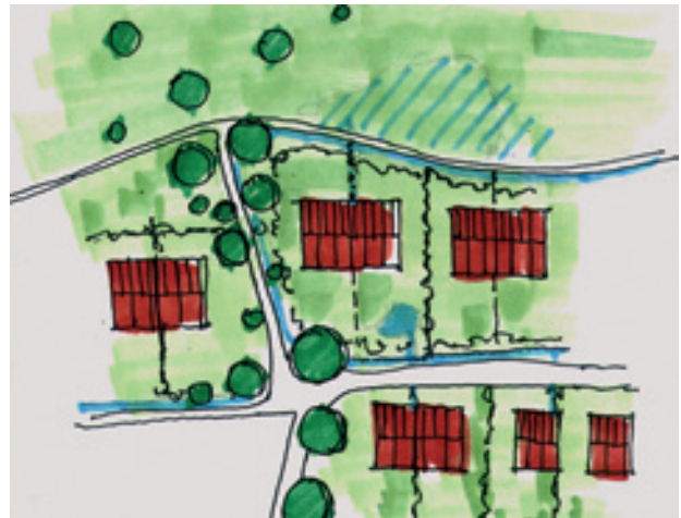
Bild 1: Vorschlag zur Änderung der planerischen Vorgaben in der Vorstudie von 2001. Mit blauer Schraffur ist in der Grünfläche im oberen Teil des Ausschnittes bereits eine Versickerungsmulde dargestellt. Blaue Linien markieren den Verlauf von Rigolen, der blaue Punkt zeigt einen Notüberlauf.
