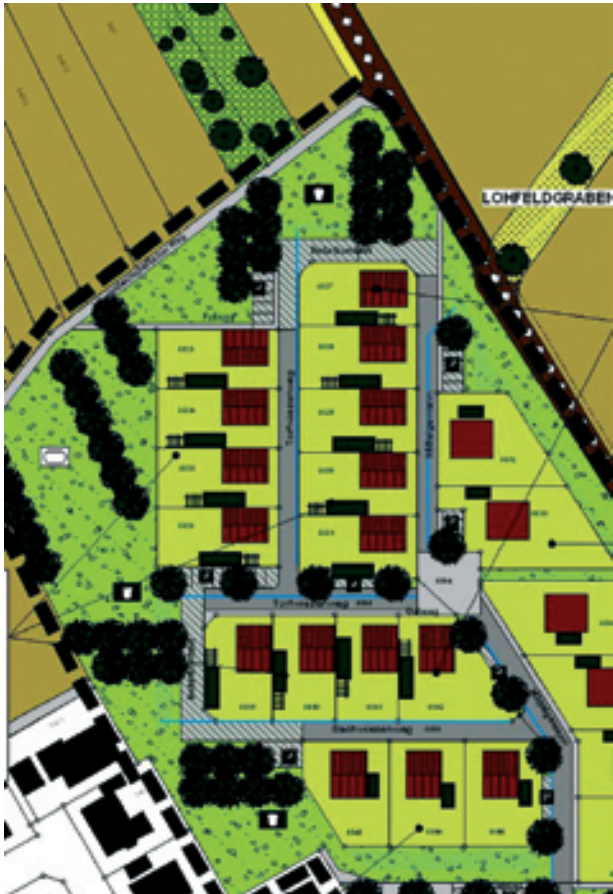
Bild 2: Ausschnitt aus dem Gestaltungsplan zum Satzungsbeschluss (2003). Blaue Linien im Baugebiet = Oberirdische Regenwasserableitung. Blaue Schraffur in den (öffentlichen) Grünflächen = Versickerungsmulden
