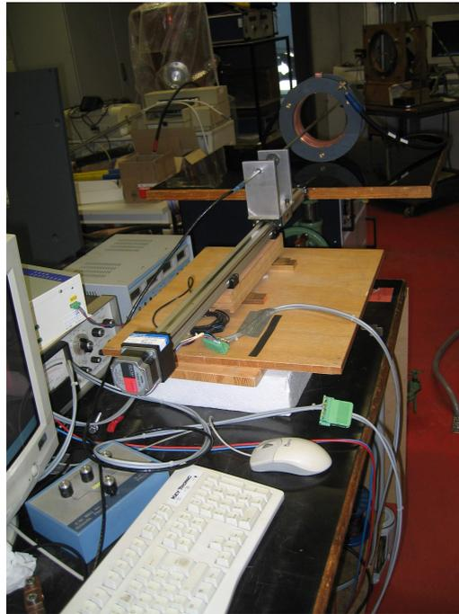
**Abbildung 5.11:** Messaufbau zur Bestimmung der magnetischen Induktion der Testspule.
