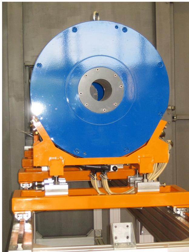
**Abbildung 3.10:** Montierter Solenoid Typ I.
