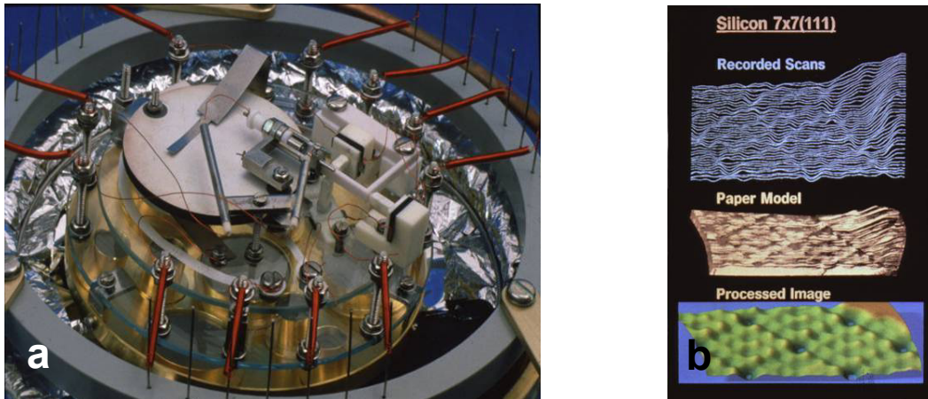
Abb. 2-1 a) Detailaufnahme des ersten bei IBM 1981 gebauten STMs und b) der mit diesem STM atomar aufgelösten 7x7 Silizium (111) Rekonstruktion (freundlicherweise zur Verfügung gestellt vom IBM Forschungslabor Zürich)
