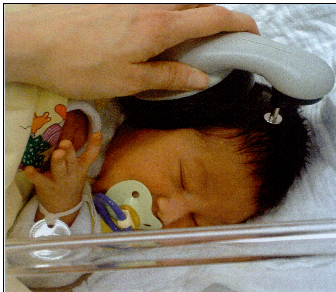
Abb.6: richtige Positionierung des Hörers beim MB11 BERAphon® (MAICO-MB11 BERAphon®-Bedienungsanleitung)
