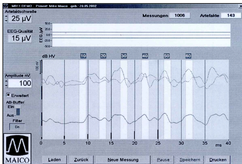
Abb.5: Testbildschirm MB11 BERAphon® nach Finkenzeller (Zeitgang-AABR) im erweiterten Modus mit A- und B-Speicher (Erläuterungen im Text)
