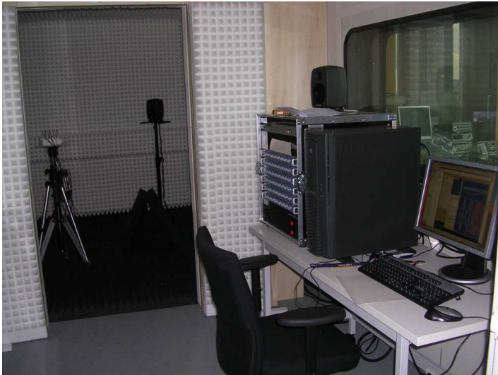
Bild 6.13: Kontrollrechner mit Vorverstärkern und Messaufbau im Hintergrund (Heptapol-Array).
