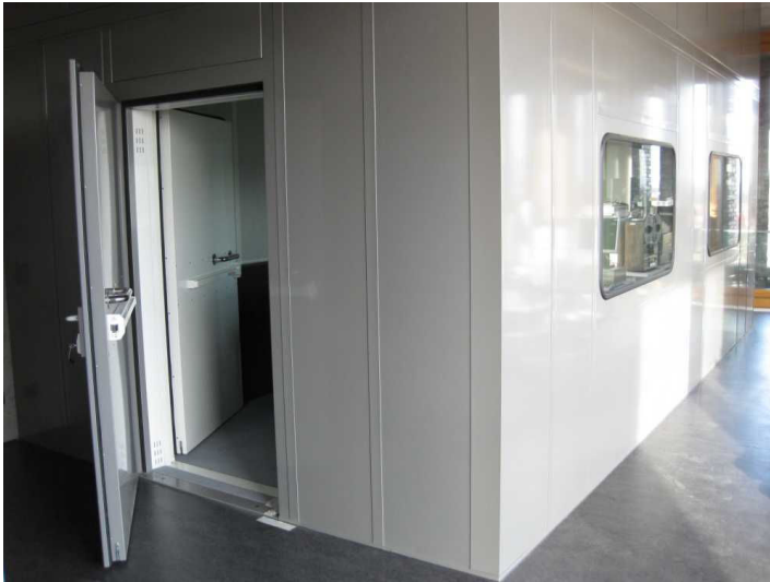
Bild 6.1: Außenansicht der Akustik-Messkammer.
