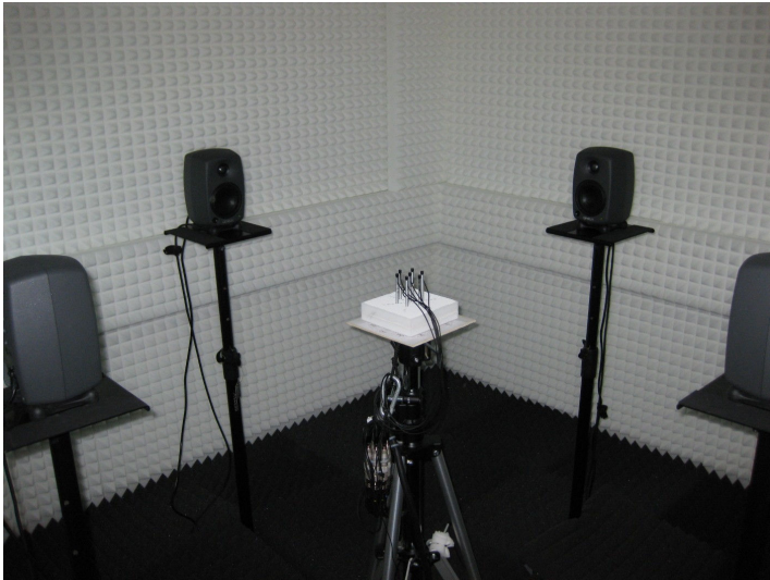
Bild 6.29: Heptapol-Array (Radius: 3 cm) mit Schallquellen.
