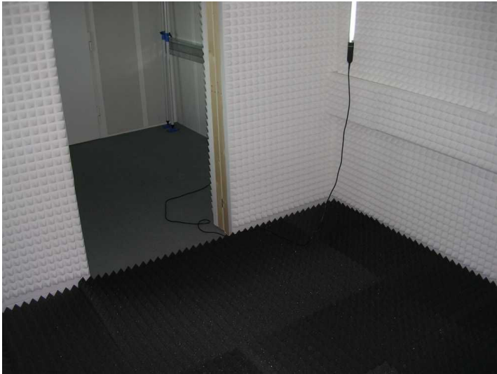
Bild 6.7: Boden des Messbereiches, ausgelegt mit PU-Schaumstoff.
