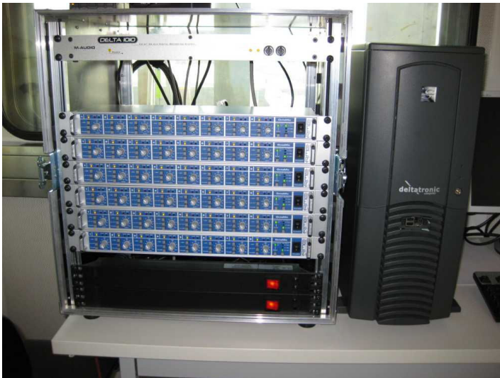
Bild 6.10: 19-Zoll-Rahmen mit einem M-Audio Delta 1010 Audiointerface und sechs RME Octamic-D Vorverstärker-Wandler-Modulen. Rechts: Lüfterloser PC mit zwei ADAT-Karten ( RME HDSP 9652 ).
