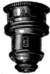
Fig. 19. Achromatisches Linsensystem mit Korrektionsapparat.
