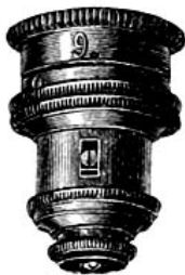
Fig. 53. Linsensystem mit Korrektionsapparat.
