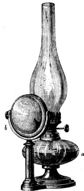
Fig. 66. Mikroskopirlampe von Hartnack.
