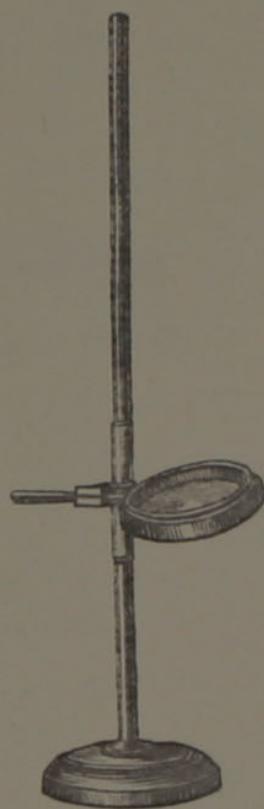
Fig. 28. Einfachste Art der Stativlupe. Die Linse ist an dem Stativ mittelst einer Hülse auf und ab, in der Hülse selbst durch eine kurze Stange hin und her zu bewegen.
